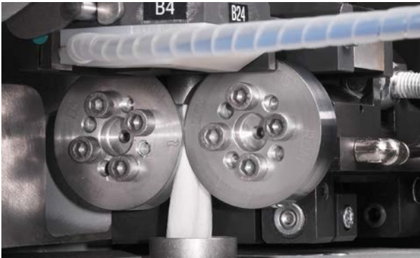
立达质量监测系统(RQM)不断检测出条定量
