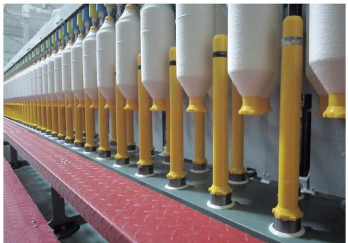
Substituição eficiente das bobinas cheias
