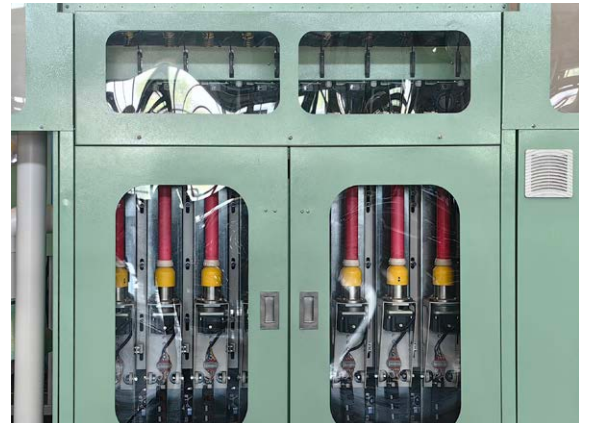
Masura temizliği için bağımsız bobin sıyrıcı
