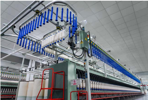
Bir sonraki boşaltma işleminden önce 220 ön iplik bobininin güvenilir şekilde değiştirilmesi
