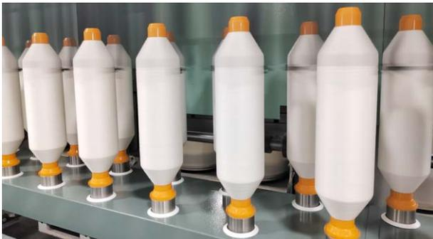
Formación precisa de las bobinas para una alta calidad de mecha
