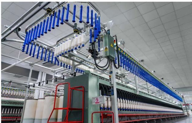
Cambio confiable de 220 bobinas de mecha antes del siguiente proceso de mudada
