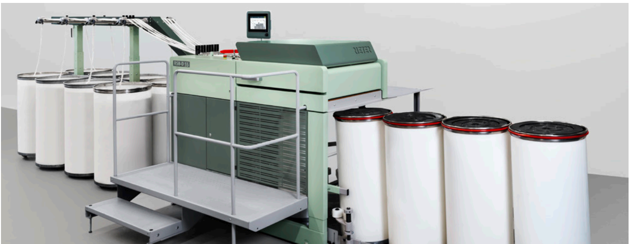
立达自调匀整并条机RSB-D 55可在稳定运行的同时保证高品质和卓越生产力
