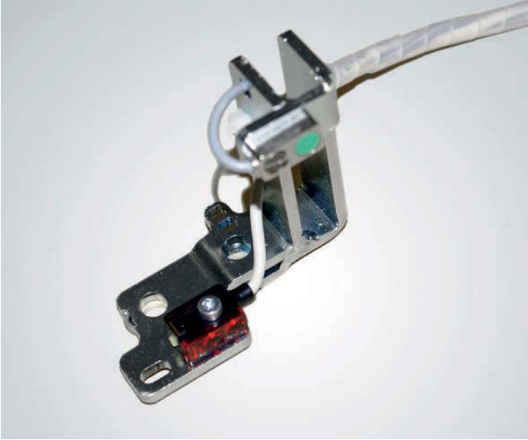
Şekil 2 B200 kayış izleyici (alt solda) ve temassız B2 EVO+ hız sensörü (üst sağ) eski cer makinalarında iyi şerit kalitesini garanti eder.
