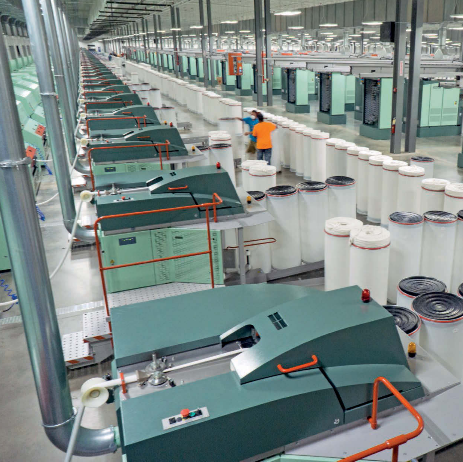
Şekil 2 RSB-Modüllü C 70 tarak makinası – Open end iplik makinaları için daha kısa proses ve optimum şerit hazırlama.
