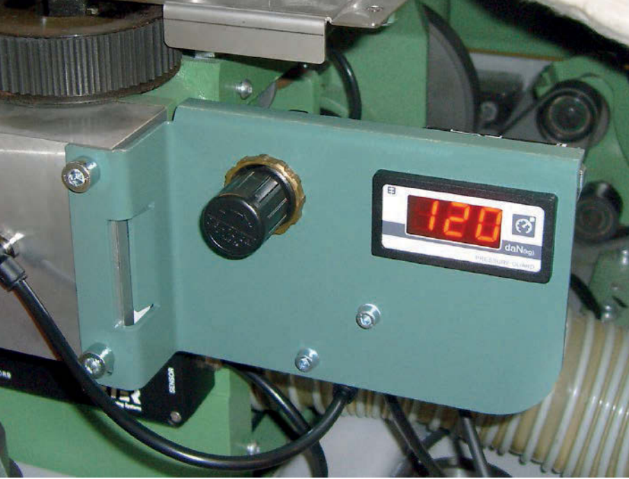
Şekil 1 Mevcut cer makinalarında, yeni basınçlı hava izleyici PRESSUREguard kontrolsüz ve düşük şerit kalitesini önler.
