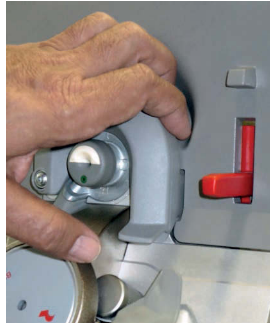
Şekil 3 Yeni S 66 eğirme kutusu kolayca açılabilir ve operatöre zaman kazandırır.
