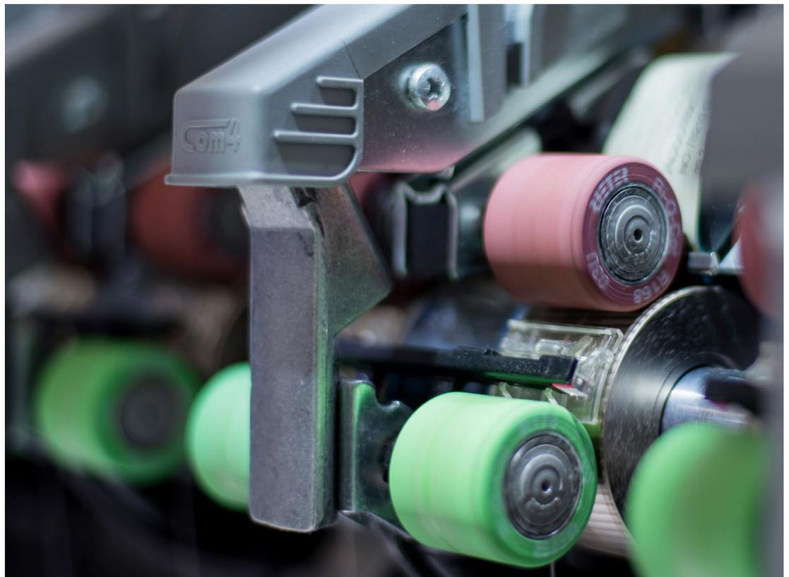
**Abb. 3** Die Kompaktspinnmaschine der K 46 mit eingebauter Stufenbrücke und Käfig ACP.
