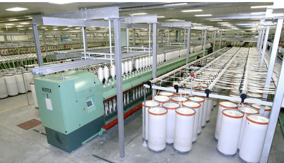
**Abb. 2** Unabhängig von der Kannenfüllung sind die Teller mit dem Rohmaterial immer gerade und auf etwa gleicher Höhe, was die Bandqualität sichert.
