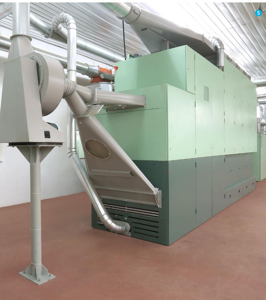
Ein herausragendes Merkmal der Karde C 70 ist die grösste aktive Kardierfläche für Höchstleistungen bei exzellenter Qualität. Die effiziente Reinigung bei hoher Produktion wird durch die selektive Schmutzausscheidung an verschiedenen Stellen erreicht:
