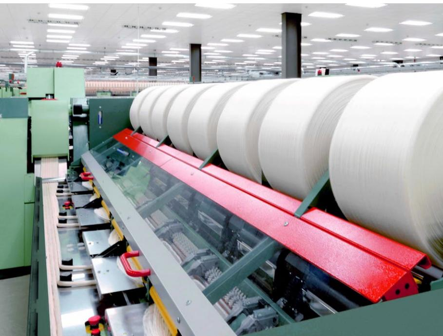
Des Weiteren erreicht die E 86 eine verbesserte Staub- und Schmutzausscheidung von bis zu 20 %. Der Kurzfaseraanteil, die Haarigkeit sowie die Gleichmässigkeit im Garn bleiben unverändert (Abb. 5).
