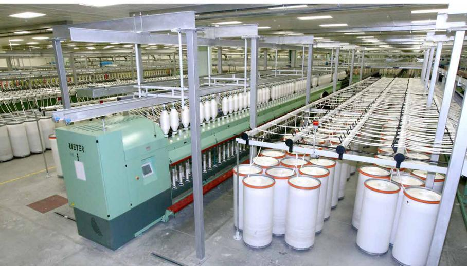
图2. 无论条筒圈放多少条子，放置条子的底板能始终保持平直状态和几乎相同的高度，从而确保条子的质量。
