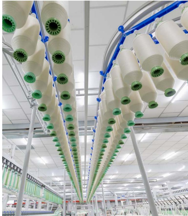
Abb. 6: Das Flyerspulentransportsystem SERVOTrail ermöglicht eine platzsparende und sichere Zwischenlagerung von Flyerspulen.
