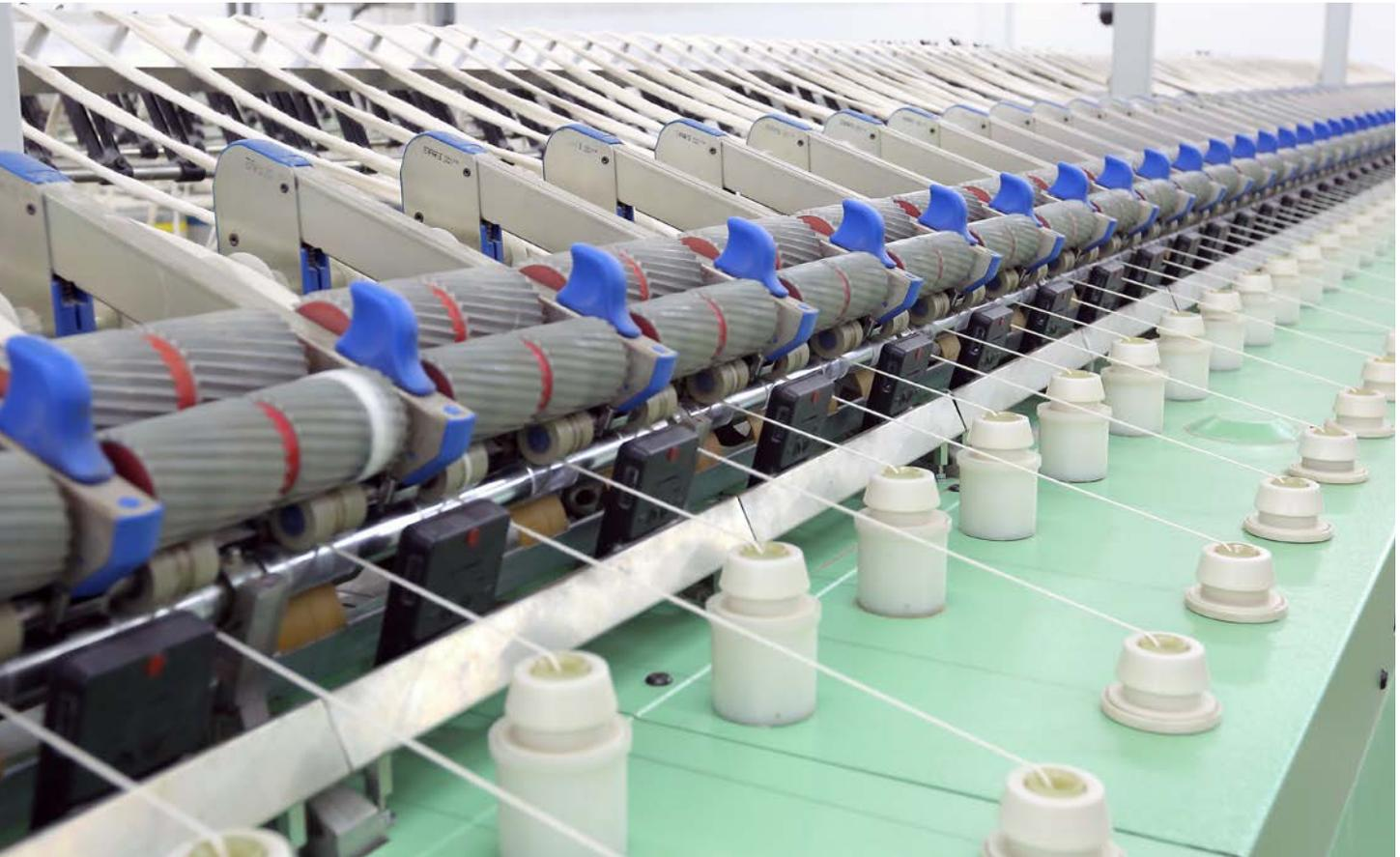
Abb. 4: Die Vorgarnspannungsregelung und die Einzelvorgarnüberwachung mit integrierter statistischer Auswertung sichern eine konstante Qualität.
