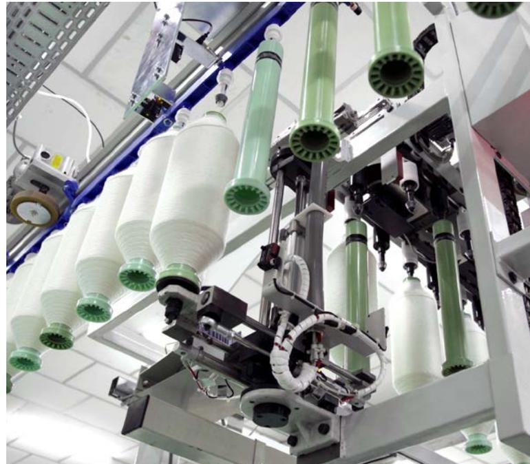
**Abb. 3:** Der Spulenumsetzer kann am Kopf oder am Fuss der Maschine installiert werden. Das erleichtert die Integration in ein Transportsystem.
