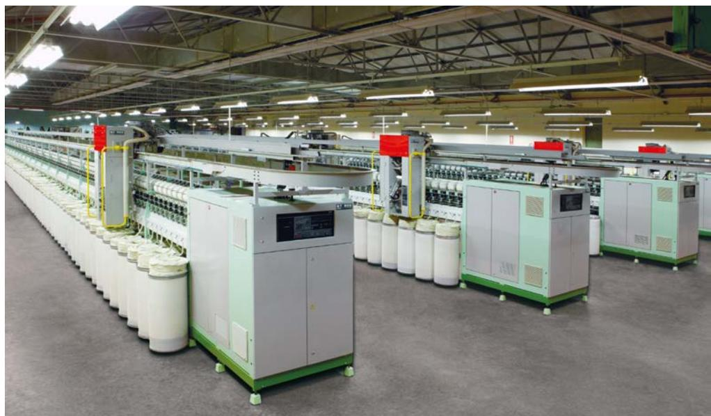
**Abb. 6:** Spinnerei in Spanien mit mehreren Maschinen des Typs BT 905 zur Verarbeitung regenerierter Fasern
