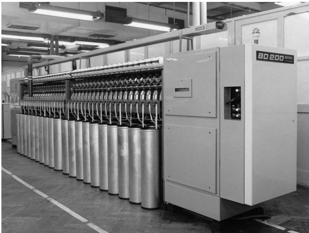
Abb. 4: Rotorspinnmaschine BD 200-M – das erste Modell, bei dem das Band in Kannen vorgelegt wurde
