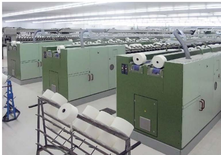
**Abb. 7:** 2005 überschritt die Maschine BT 923, hier in einer Spinnerei in Thailand, zum ersten Mal die magische Grenze von 100 000 Rotorumdrehungen pro Minute.
