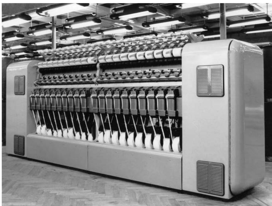
**Abb. 1:** Das weltweit erste Modell einer Rotorspinnmaschine, bei der die Streckwerke durch Auflösewalzen ersetzt wurden (Basis für die M 40-V)
