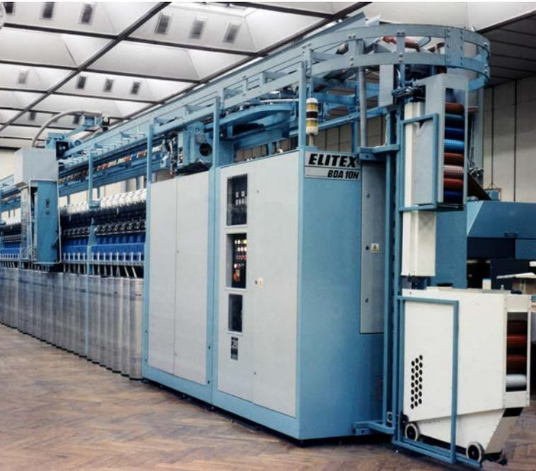
**Abb. 5:** Die erste automatische Rotorspinnmaschine – BDA-10 – mit automatischem Rotorreinigen und Anspinnen
