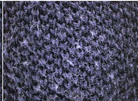
**Abb. 1:** Der Pilling-Test zeigt deutliche Vorteile für das «Rieter»-Poloshirt aus Com4®jet-Garn.
