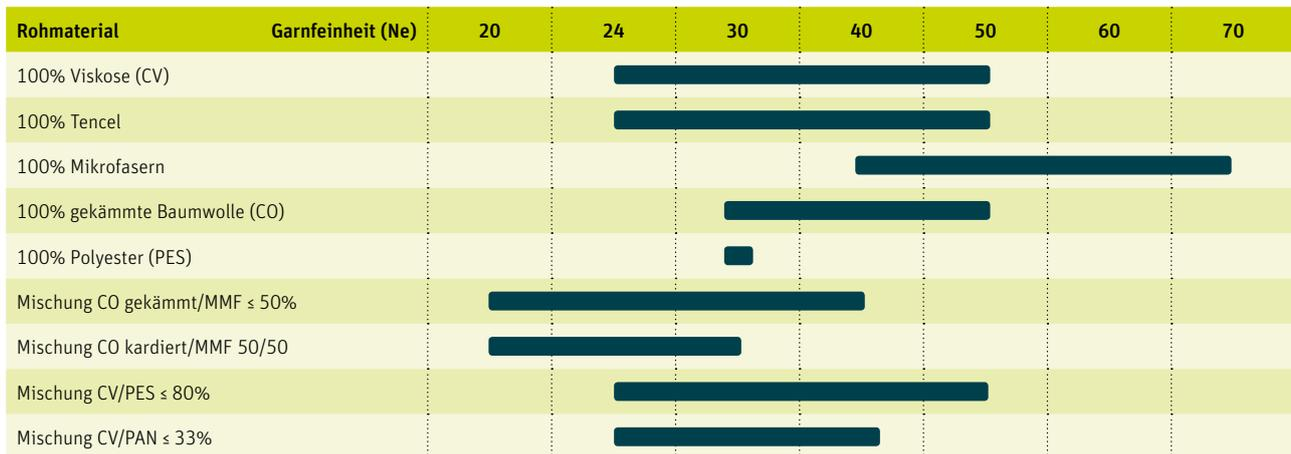
Abb. 5: Neue Märkte erschliessen: Die Luftspinnmaschine J 26 bietet neu eine grössere Rohstoffauswahl und einen breiteren Garnfeinheitsbereich.
