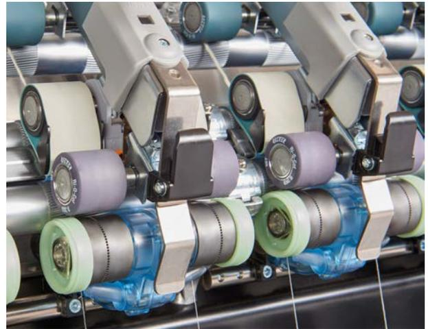
Die Kompaktiereinheit COMPACTdrum ermöglicht auch auf bestehenden Rieter-Maschinen das wirtschaftliche Spinnen von hochwertigem Kompaktgarn.
