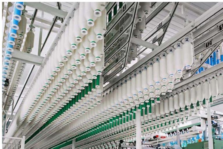
**Abb. 3:** SERVOTrail automatisiert den Spulentransport und spart Platz.
