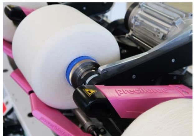
Das Anpresskraftsystem preciforce ermöglicht das Herstellen von Färbespulen mit konstanter Farbqualität und hoher Produktivität.
