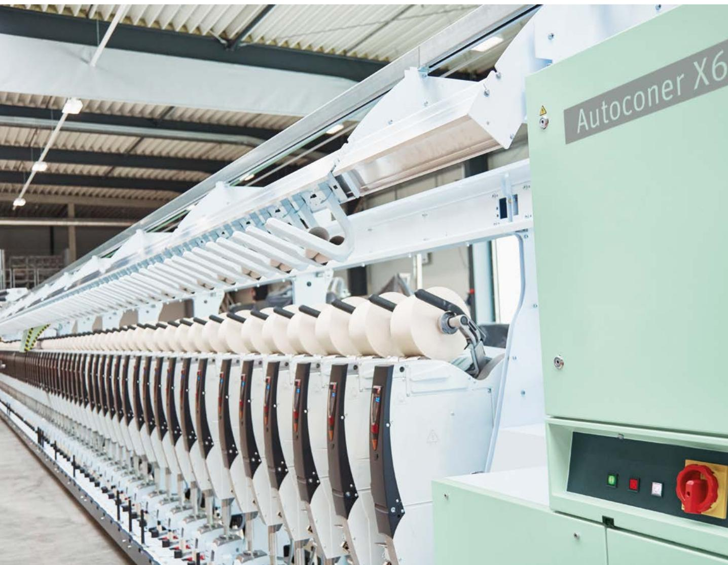
图1：自动络筒机Autoconer X6保证环锭纺和紧密纺加工的最终产品质量。
