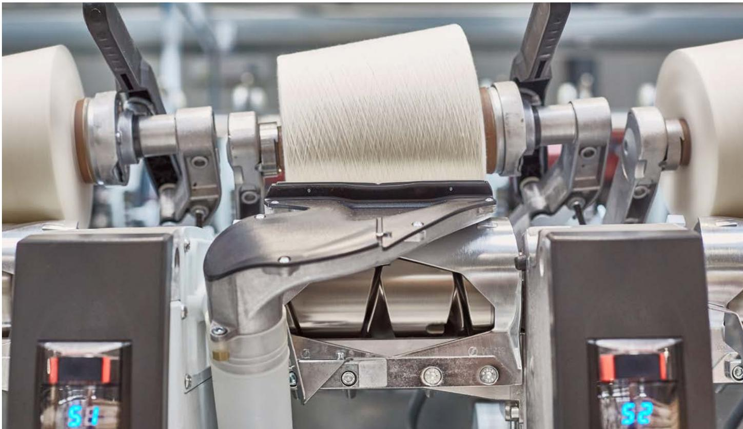
图5：智能启停程序可提高上纱头搜寻和有疵纱线清理的效率
