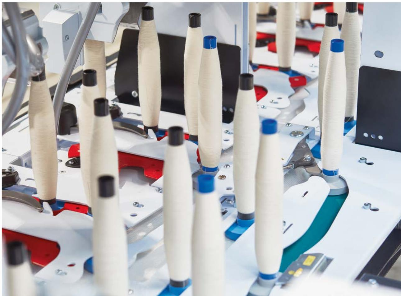
图4：带有Multilot功能的多联式细络联Multilink系统可处理多达四种不同的喂入原料。
