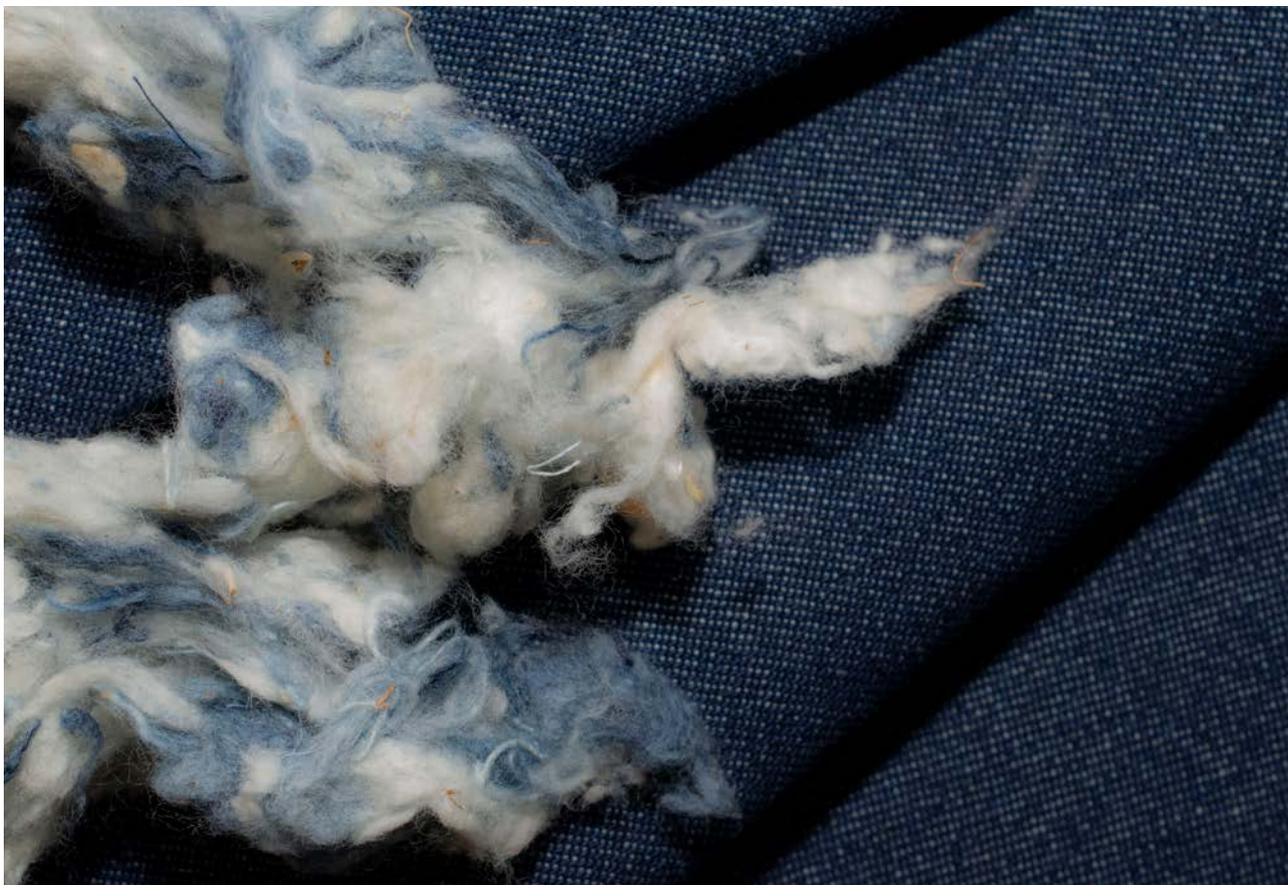
图1：使用70%的原棉和30%的消费后再生纤维加工的牛仔织物具有优异质量。
