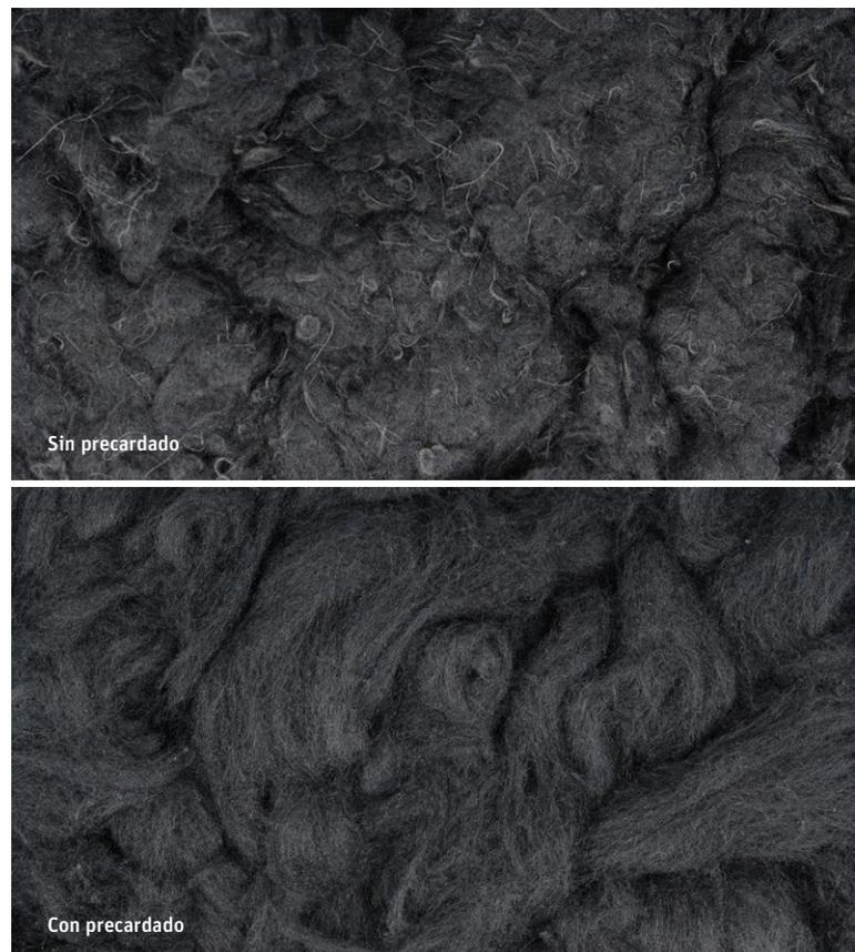
**Fig. 1:** El material precardado no contiene trozos de hilo, lo que mejora la capacidad de hilatura del material reciclado.
