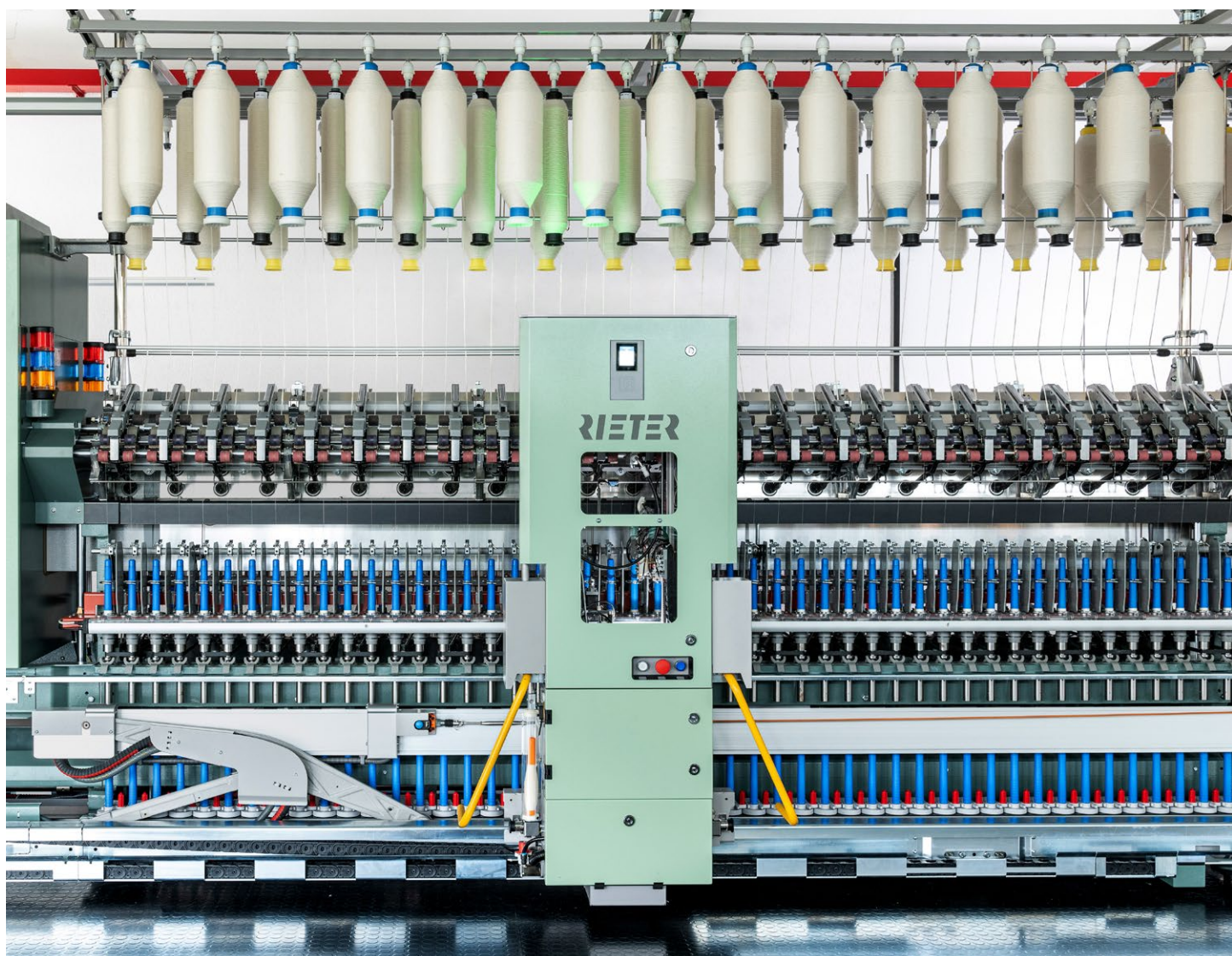
图2：全自动接头机械手ROBOspin全天候运行，始终维持高产，促进纱厂后纺流程。
