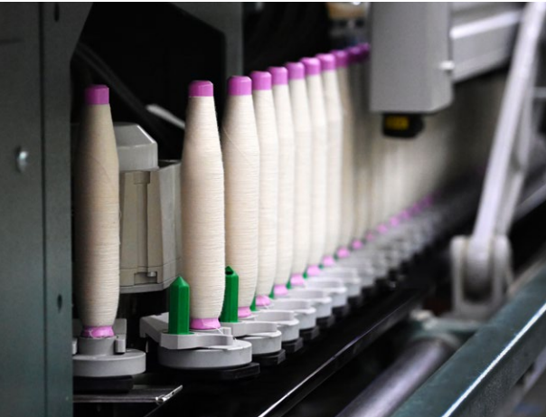
图3：SERVOdisc将管纱运输速度提高12%
