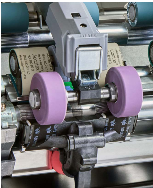
Abb. 1: Eine intelligente Lösung: Umrüstung veralteter Rieter-Kompaktspinnmaschinen zu konventionellen Ringspinnmaschinen – mit optionalen Kompaktiereinheiten
