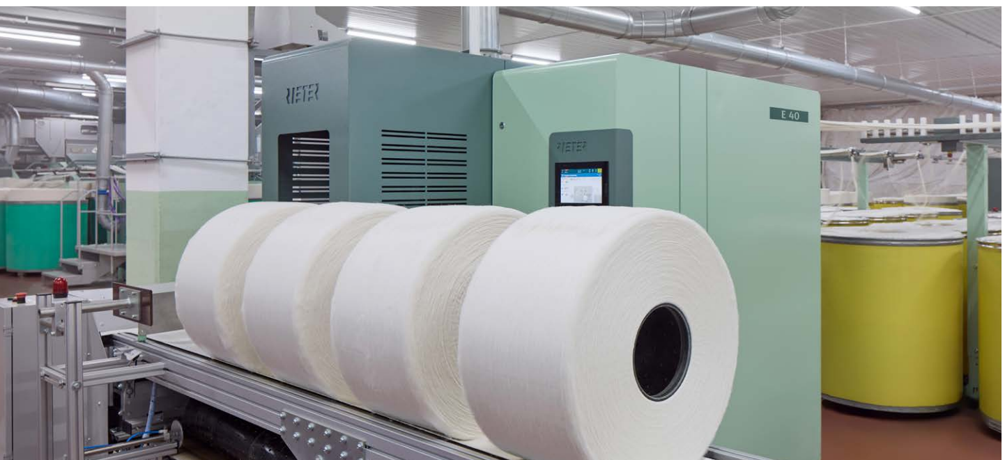
Abb. 1: Die neue Kämmereivorbereitung OMEGAlap E 40 punktet mit schnellem Wickelwechsel und einfacher Wartung.
