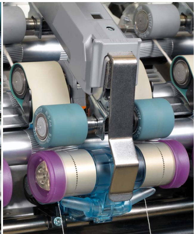
Abb. 1: Eine intelligente Lösung: Umrüstung veralteter Rieter-Kompaktspinnmaschinen zu konventionellen Ringspinnmaschinen – mit optionalen Kompaktiereinheiten
