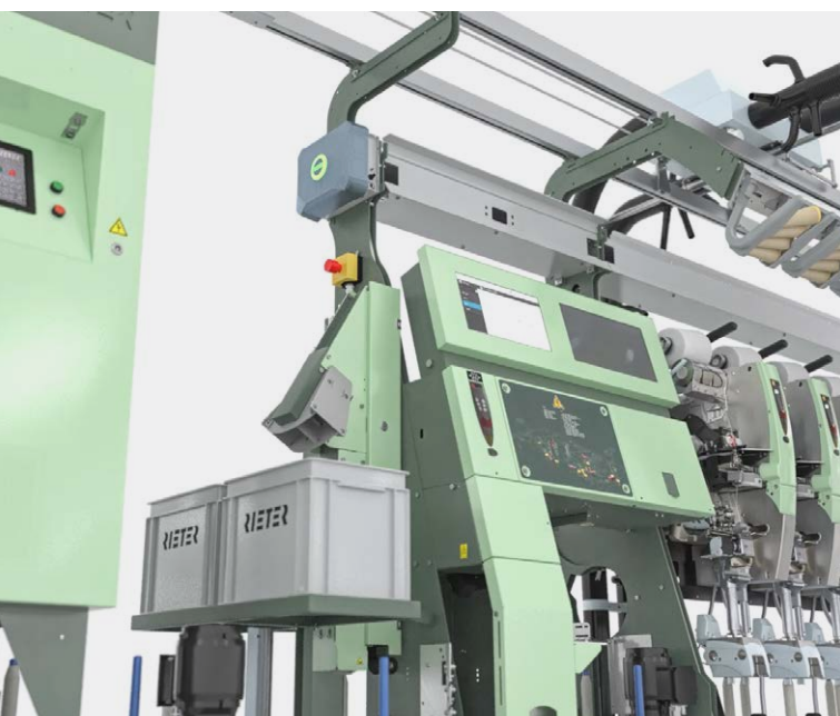
Fig. 1: La Autoconer X6 con el nuevo intercambiador de canillas automático reduce la carga de trabajo y aumenta la fiabilidad del proceso.
