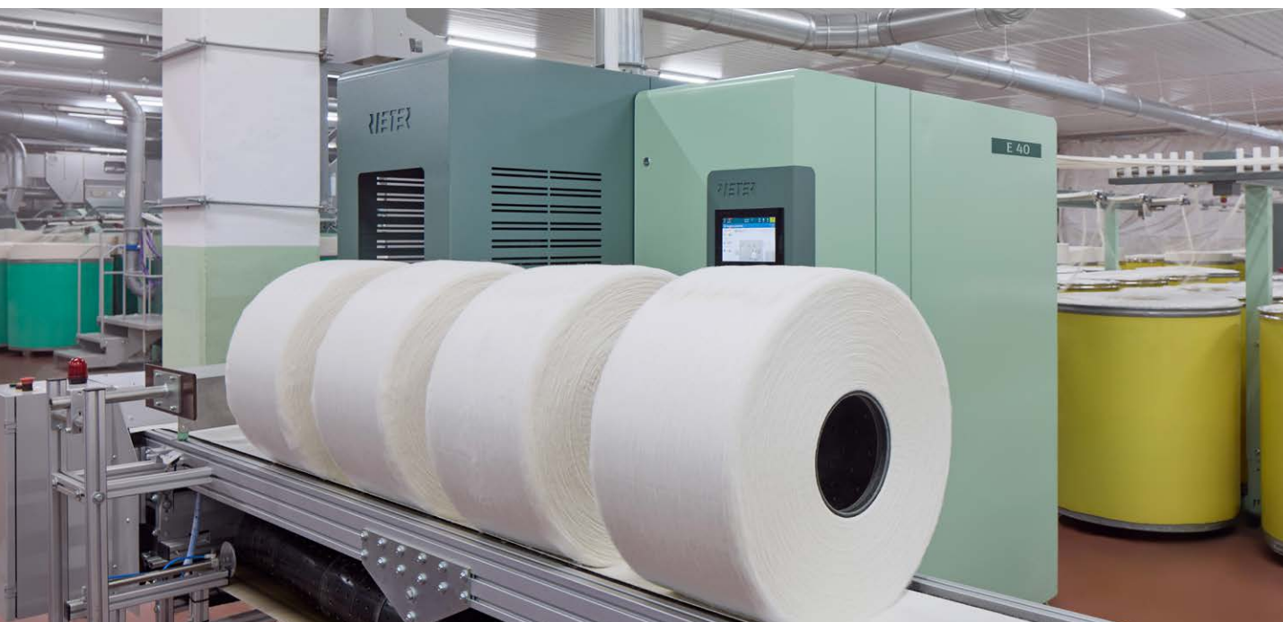
Fig. 1: La nueva máquina preparadora de peinado OMEGAlap E 40 destaca por los rápidos cambios de rollos y su mantenimiento sencillo.
