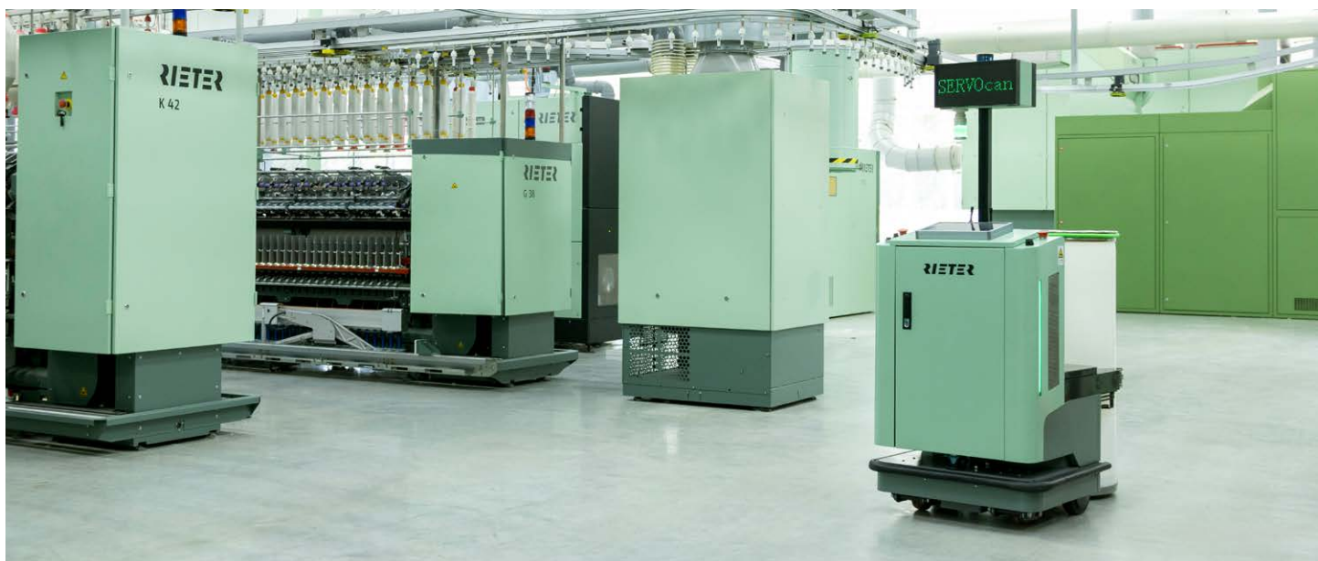
Fig. 2: El transporte automático de botes se encarga de tareas monótonas y de exigencia física.
