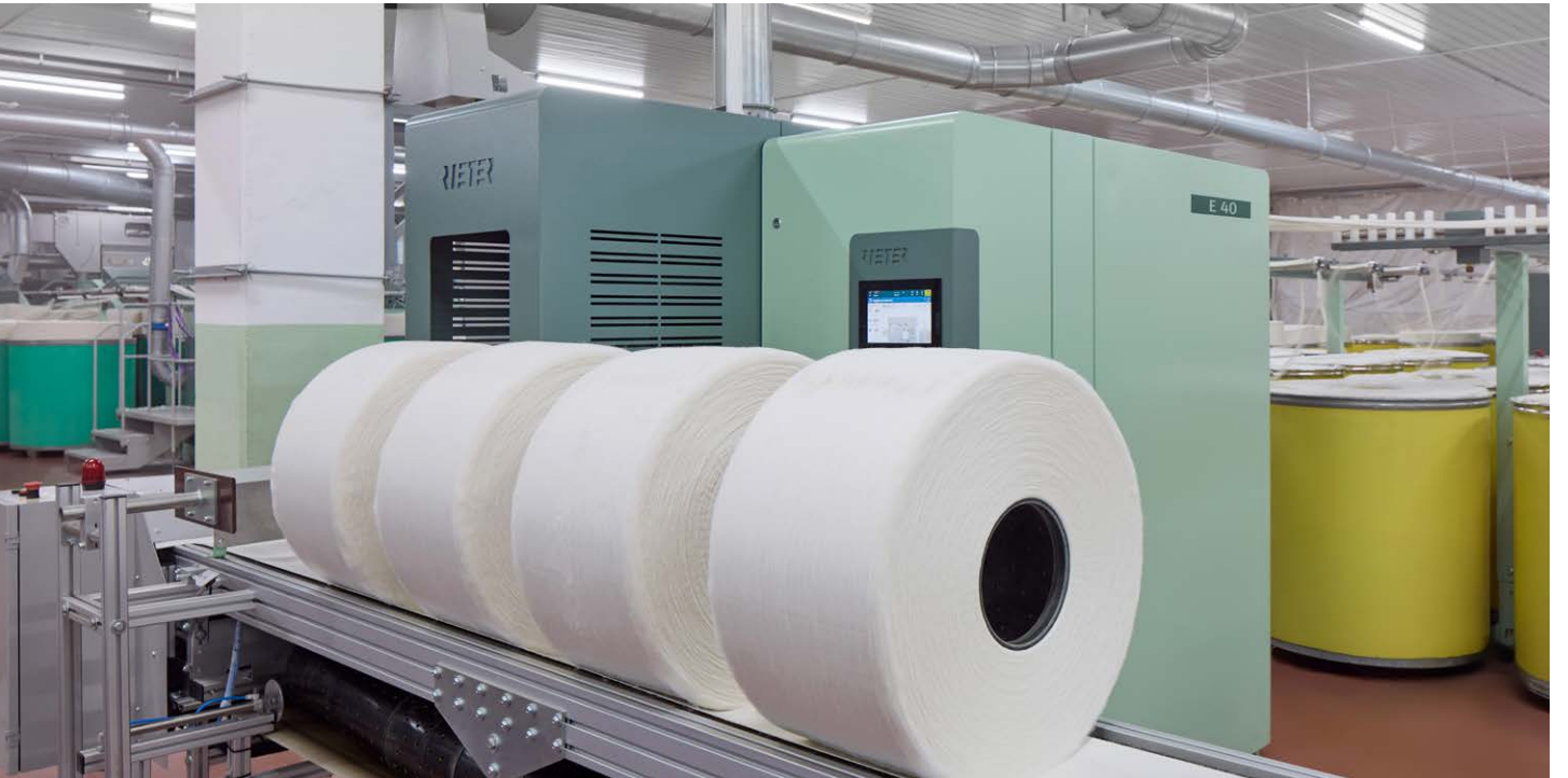
Şek. 1: Yeni penye hazırlık makinası OMEGAlap E 40, hızlı vatkı değişimi ve kolay bakımıyla dikkat çekiyor.
