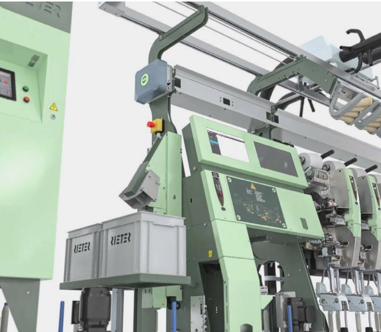
Şek. 1: Autoconer X6, yeni otomatik Kops Değiştirici ile personelin iş yükünü azaltır ve proses güvenilirliğini artırır.
