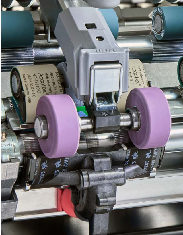
Şekil 1: Akıllı bir çözüm: eskiyen Rieter kompakt iplik makinalarını, opsiyonel kompaktlama aparatları ile geleneksel ring iplik makinalarına modifiye edin.
