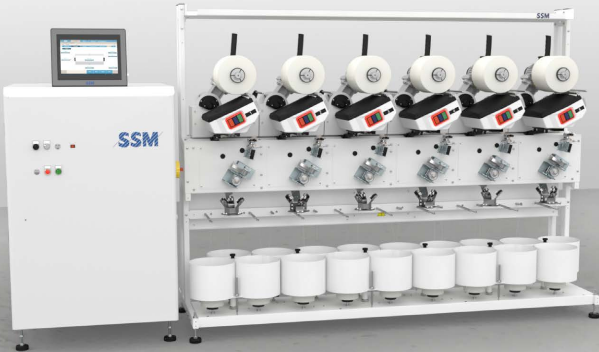
Şekil 1: NEO-BD hassas bobin makinası: üstün bobin sarımı için gelişmiş tekstil üretim teknolojisi.
