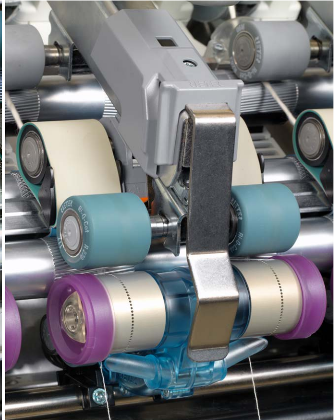
Şekil 1: Akıllı bir çözüm: eskiyen Rieter kompakt iplik makinalarını, opsiyonel kompaktlama aparatları ile geleneksel ring iplik makinalarına modifiye edin.
