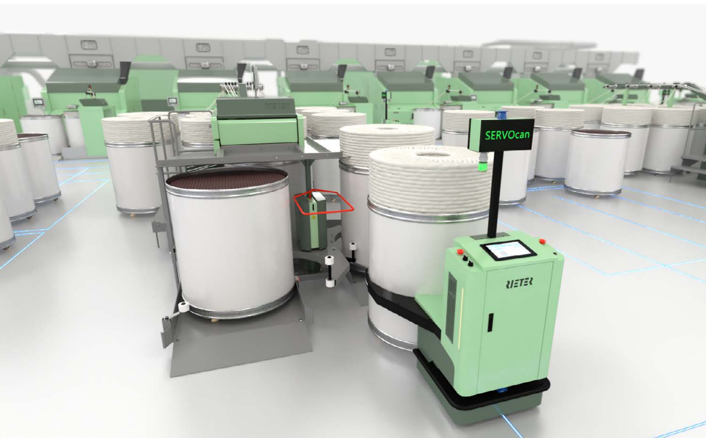
图1：立达纱厂全自动化，每10 000锭只需3位挡车工，每班可生产1.9吨纱线（基于：100%精梳棉，30英支，机织纱）。
