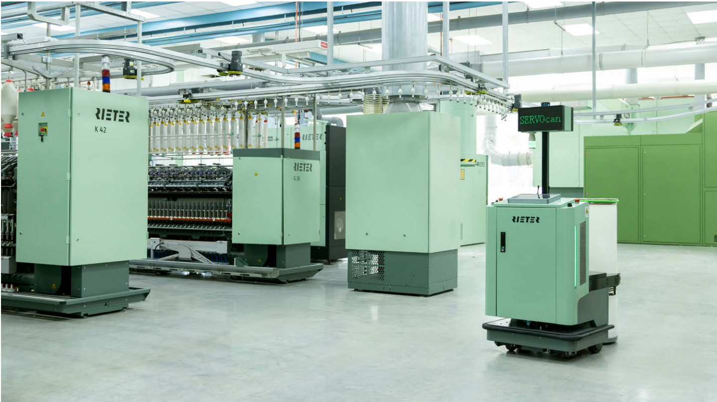
图2：自动化条筒运输系统接管单调繁重的任务。
