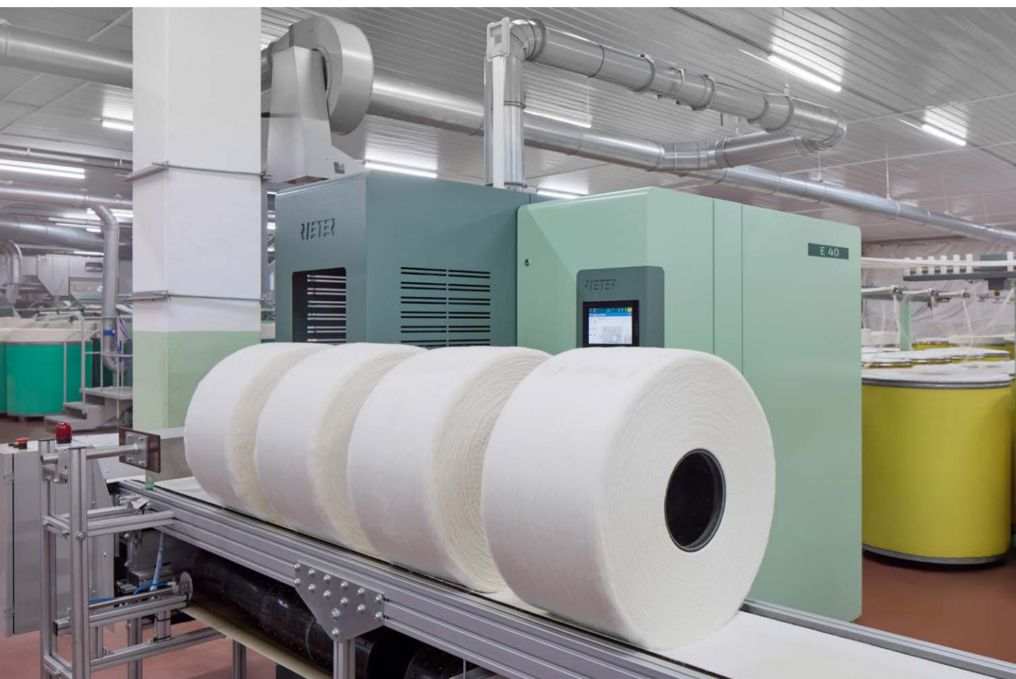
图1：新型条并卷机OMEGAlap E 40：换卷速度快且易于维护。
