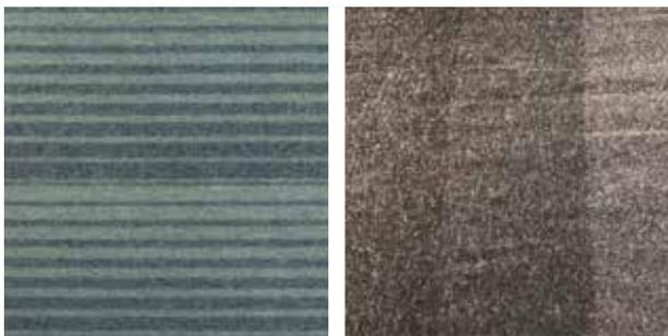
采用fancyflex™VARIO图案模式面料的示例，采用不同的时间或一种纱线的三种超喂量，产生三种灰色阴影。
