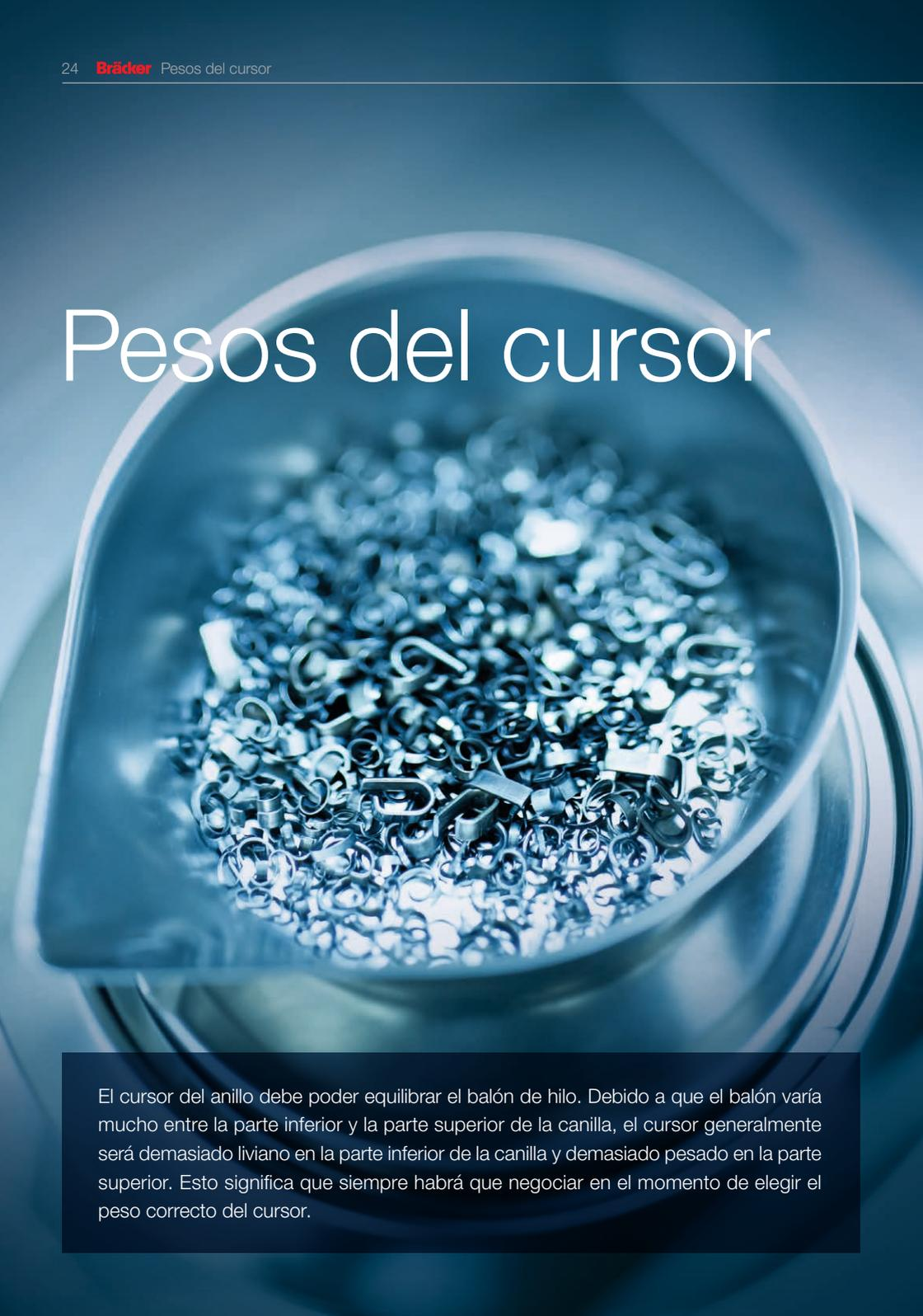
El cursor del anillo debe poder equilibrar el balón de hilo. Debido a que el balón varía mucho entre la parte inferior y la parte superior de la canilla, el cursor generalmente será demasiado liviano en la parte inferior de la canilla y demasiado pesado en la parte superior. Esto significa que siempre habrá que negociar en el momento de elegir el peso correcto del cursor.
