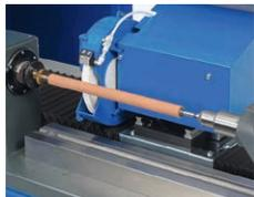
Esmerilado semiautomático de recubrimientos de preparación con diámetros de 19 a 140 mm y una longitud máxima de 500 mm
